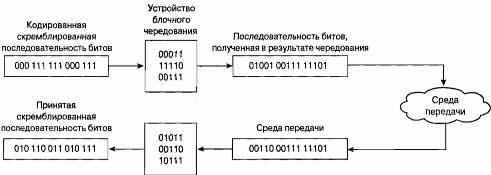
Рис. 3.5. Кодирование с блочным чередованием
