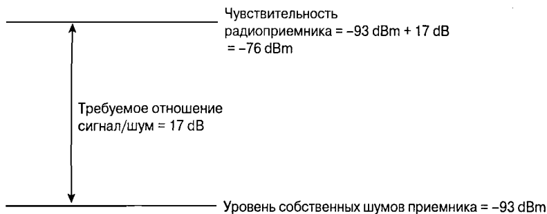
Рис. 7.5. Вычисление чувствительности приемника
